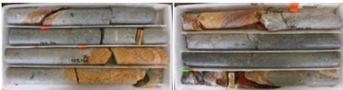
Fig. 71. Ejemplo de conducto alimentador localizado a profundidad.
