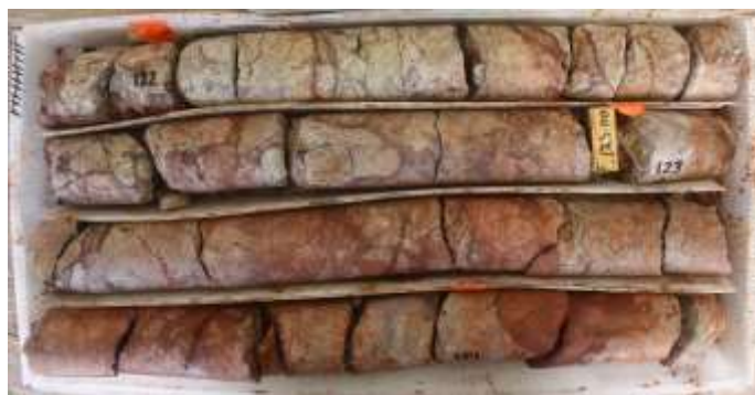
Fig. 58. Muestra de dacita porfídica (DacP) con alteración argílica avanzada (SIC) para el punto ER-03.
